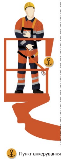
Мал. 1. Пункт анкерування у кошику мобільного підйомника
